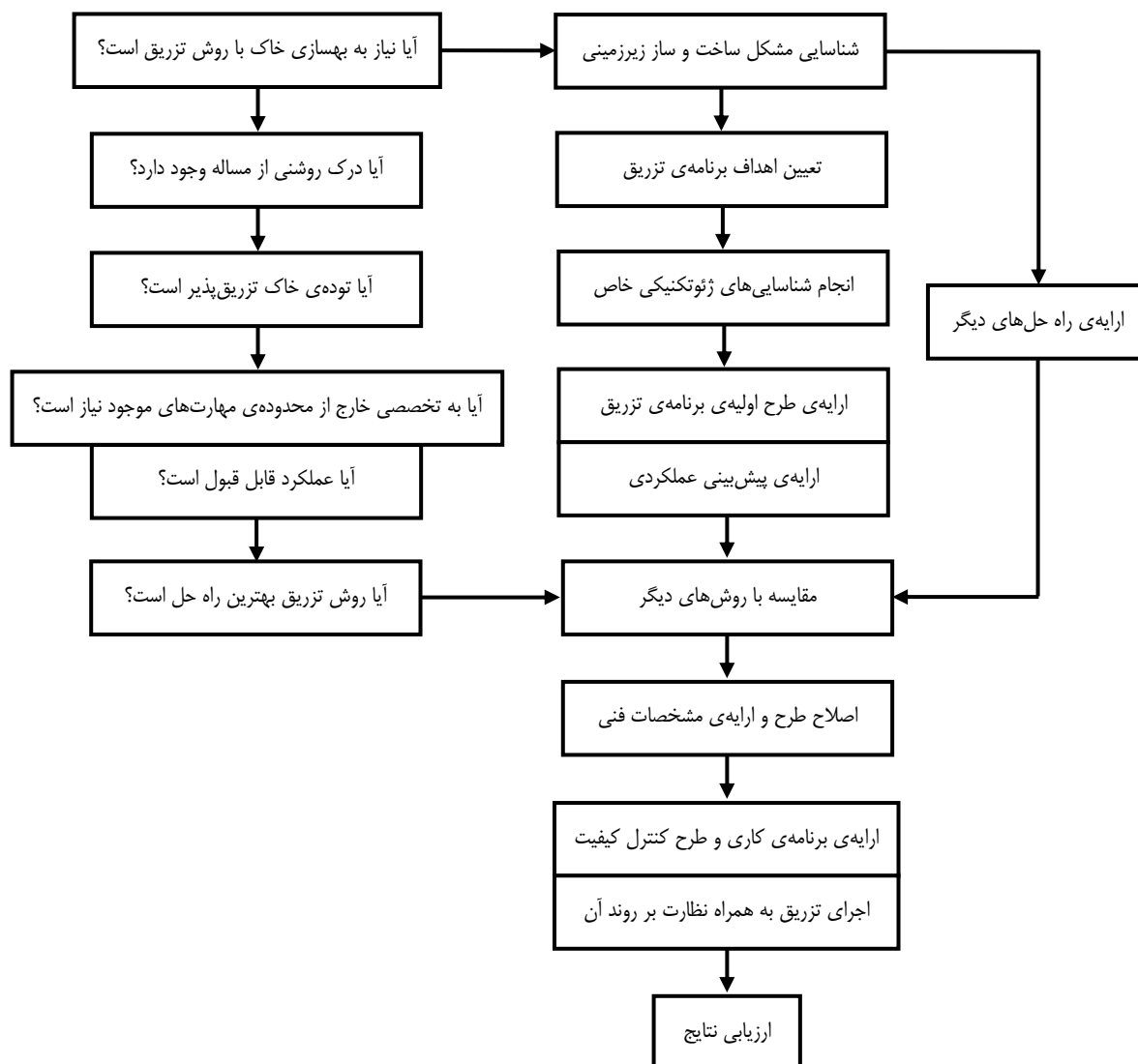
شکل ۸-۴۴- روندنمای گام‌های مختلف روش تزریق
