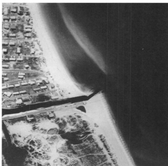
شکل ۳-۱- نمایی از ساحل مکزیک، فلوریدا، نشان دهنده تجمع رسوب در بالادست، فرسایش پایین دست ساحل و کم عمق شدگی کانال
