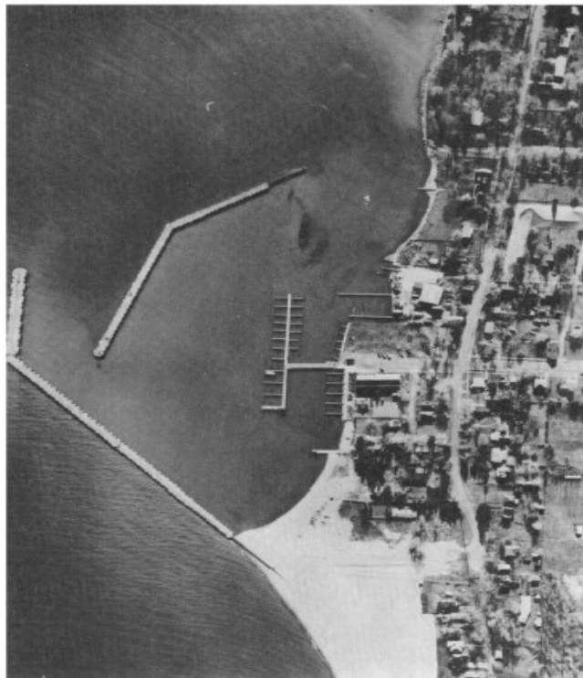
شکل ۳-۲- نمایی از بندر سانیلک، میشیگان، نشان دهنده نشست رسوب در بالا دست بندر و فرسایش پایین دست
