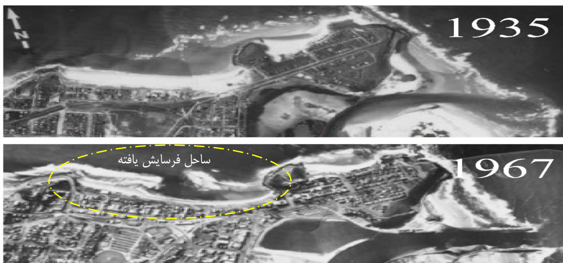
شکل ۳-۲- فرسایش شدید در سواحل شهر گلدکست پس از احداث جتی در دهانه رودخانه توئید
