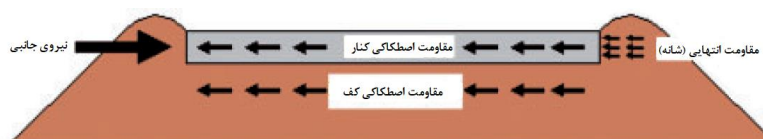
شکل (۳-۶) منابع مقاومت جانبی تراورس در تماس با بالاست (Esmaeili et al., 2015)
